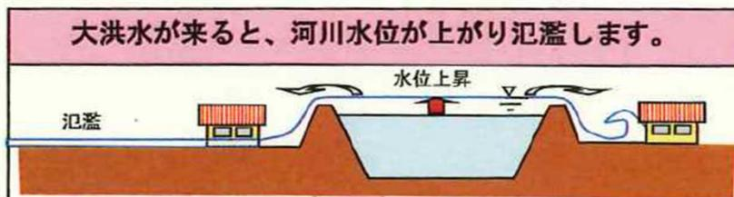
洪水時の水位が地盤高より高い区間の河川では、水位を下げるのが治水の原則
