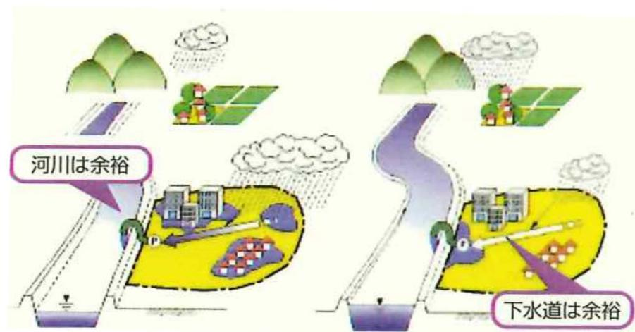
下水道の雨水排水能力を上回る浸水 あるいは河川水位の上昇により、下水道から河川へ放流できず浸水
