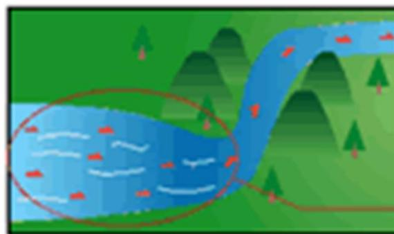
洪水時に狭窄部で流れにくくなり、上流側の水位が上昇します。
